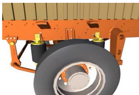
Fig. 17 Situación de los cojines neumáticos sobre el eje trasero
