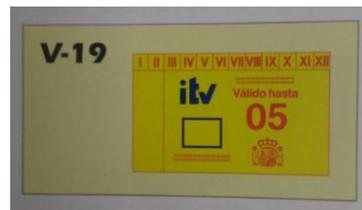
En el caso de vehículos que tengan parabrisas, el distintivo se colocará en el ángulo superior derecho del parabrisas por su cara interior. La cara impresa del distintivo será autoadhesiva.
