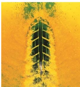
Un neumático con una mayor sección provocará una ola mayor y proporcional a esta anchura, siendo sometido a una mayor presión y pudiendo perder más fácilmente la adherencia o contacto con el pavimento. Para paliar este inconveniente, los neumáticos deben disponer de un mayor número de canales o ser éstos de un mayor tamaño, para una mejor evacuación del agua, que puede ser de 5 a 10 litros por segundo.
