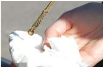
Para comprobar el nivel de aceite debes mirar la varilla indicadora cuando el motor esté parado y frío. El nivel de aceite debe estar entre las marcas de mínimo y máximo.
