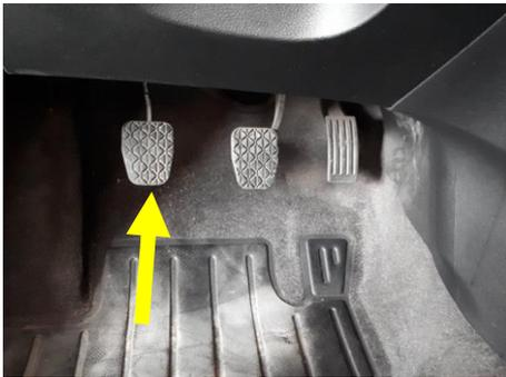
Palanca para pisar y meter las marchas de manera manual. Permite cambiar de velocidad mientras conduces para que el vehículo vaya hacia adelante y hacia atrás.
