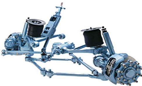
Fig. 3 Conjunto del sistema de suspensión
