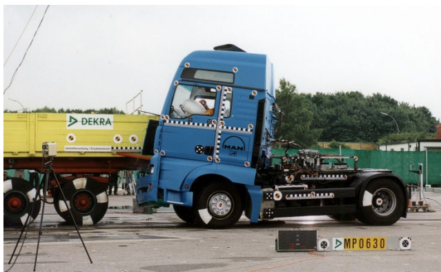
Fig. 6 Ensayo de colisión
