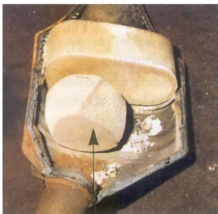
Fig. 11 Desgaste y rotura del catalizador
