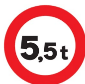
R-201 LIMITACIÓN DE MASA Prohibición de paso de los vehículos cuya masa en carga supere la indicada en toneladas.
