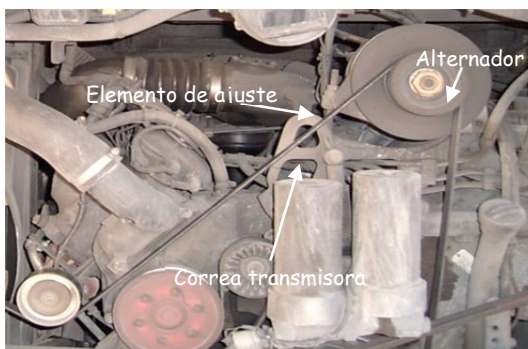
Fig. 9 Situación del alternador y ajuste de la correa
