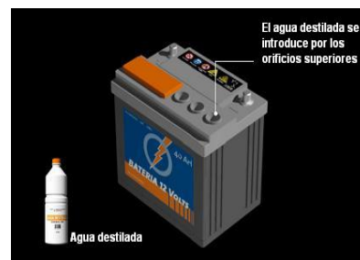
Fig. 4 Adición de agua
