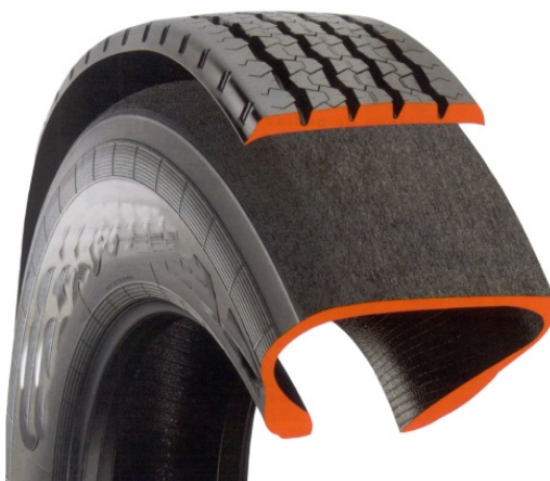
Fig. 17 Aplicación de una nueva banda
