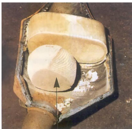
Fig. 11 Desgaste y rotura del catalizador
