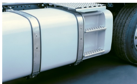
Fig. 4 Depósito y escaleras
