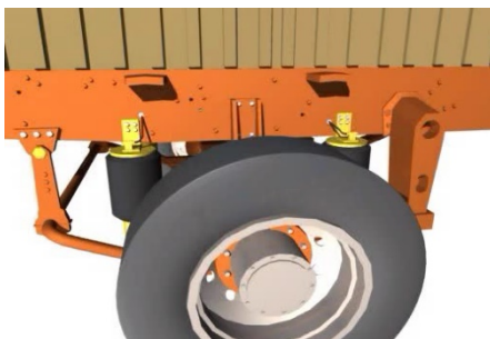
Fig. 17 Situación de los cojines neumáticos sobre el eje trasero
